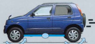
センターデフが作動し、前後輪均等に駆動力を配分
