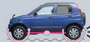
センターデフがロックされ、前後輪が直結状態
