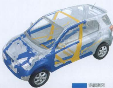
Photo:衝突安全ボディ<TAF(タフ)>。 ※写真は補強箇所を説明するために合成、着色したものです。
