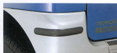
248 (P-29) バンパープロテクター (リヤ用) (ブラック/シルバー) (2個セット) 各色 ¥4,100 (本体価格¥3,500+標準取付費¥600) 同時装着不可: (テリオス) ④コーナースエンサー (リヤ) ※フロントには装着できません。
