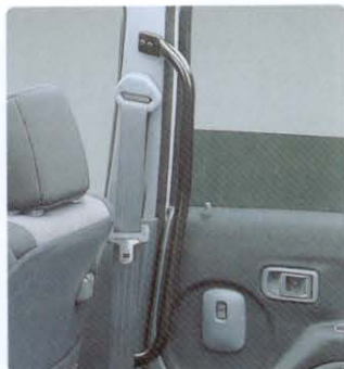
78 (P-13) アシストグリップ (センターピラー用) (片側) ¥8,000 (本体価格¥6,200+標準取付費¥1,800) 後席のスムーズな乗り降りが できます。スチール製。
